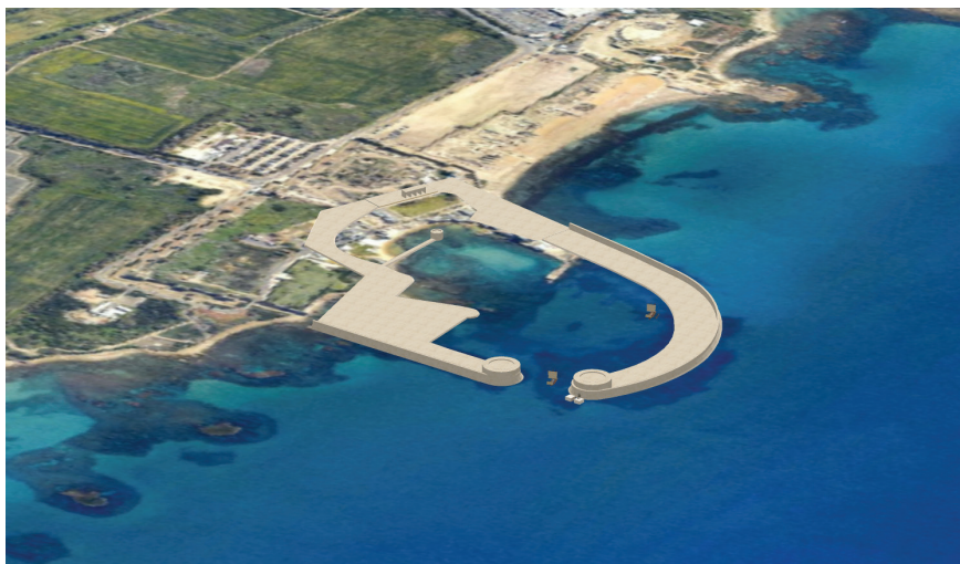
איור 14: הצעה ראשונית לשחזור מתווה שוברי הגלים בנמל קיסריה על בסיס ניתוח מפת הסונאר רב-האלומות
