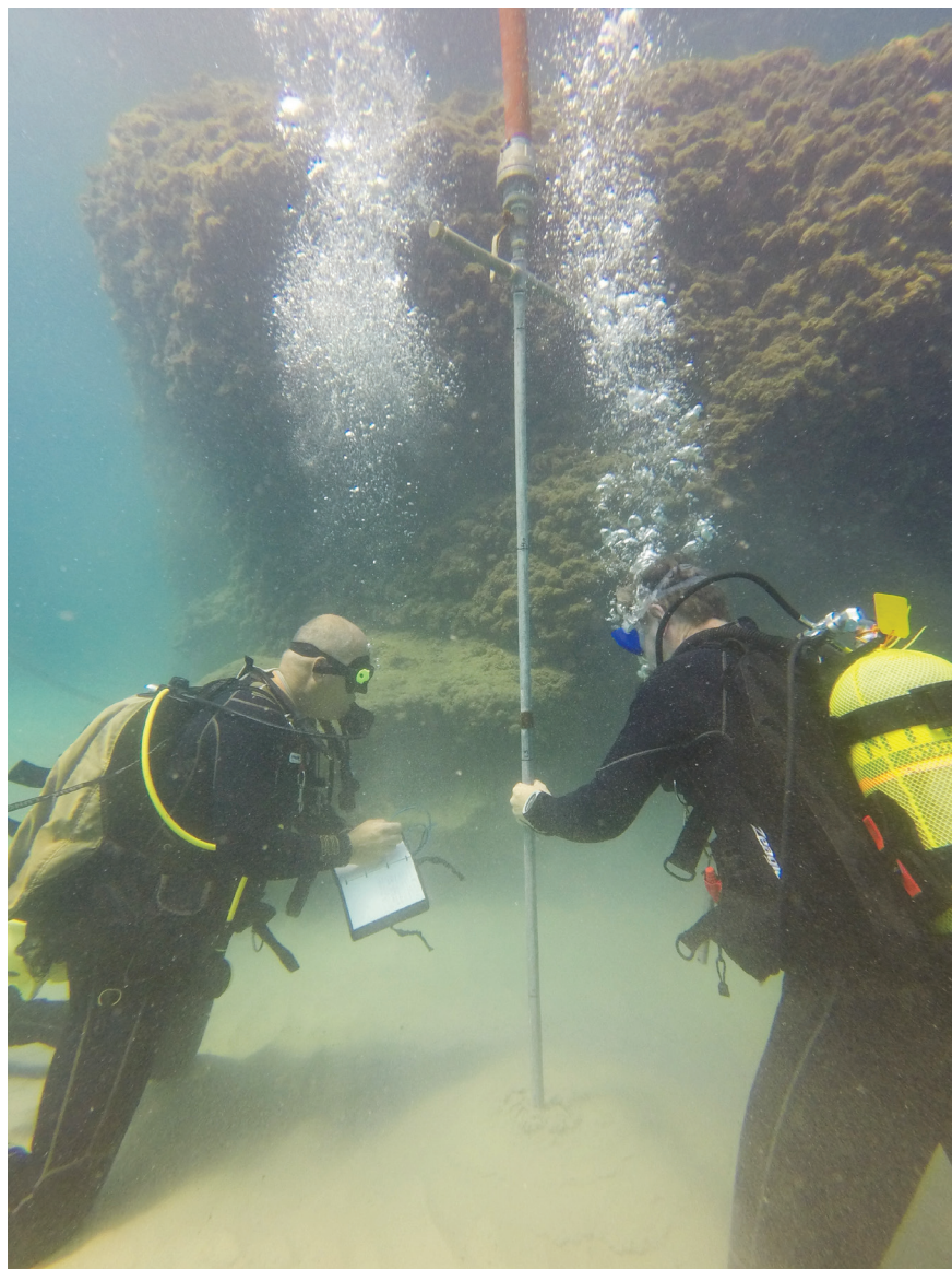
איור 5: צוללנים מבצעים קידוחי שטיפה, באמצעות סילון מים, במטרה לאתר את עומק התשתית הקשה שמתחת לחול (סלע או חרסית)
